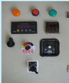
در این مدل هرگونه تنظیمات بصورت دستی و توسط کاربر صورت می گیرد و تنها مدلی است که دارای سیستم کنترلی تابلو برقی می باشد. کنترل سرعت بصورت دستی توسط اینورتر صورت می گیرد و زمان دهی بوسیله تایмер معجزا می باشد. این مدل نیز جهت تمرین دهی 10 حیوان همزمان می باشد و قابلیت اتصال به کامپیوتر را ندارد.
